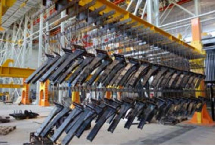
Die Schnittkanten von Leitplanken werden bei der diskontinuierlichen Stückverzinkung, also dem Eintauchen vorgefertigter Bauteile in eine schmelzflüssiges Zinklegierung, zuverlässig vor Korrosion geschützt. Im Gegensatz zur Bandverzinkung wird die schützende Zinkschicht nicht zerstört. Die neue Anlage wurde 2021 in Betrieb genommen. (© Inter Metal Sp. z o.o.)
